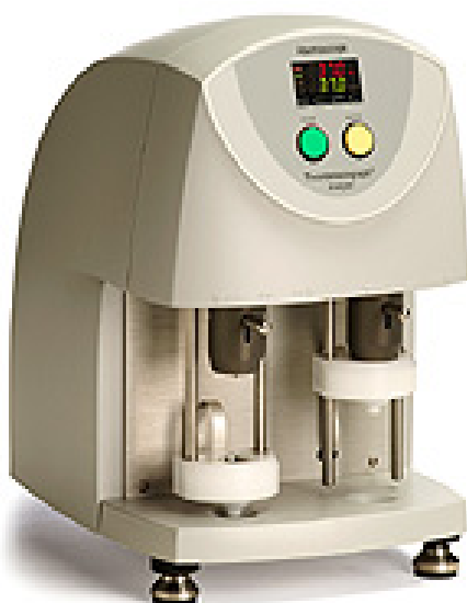
Figura 2. Ilustra um dos modelos mais usados de tromboelastógrafo, fabricado pela empresa Haemoscope. O aparelho dispõe de duas cuvetes que permitem a realização simultânea de dois exames. Quando acoplado a um notebook o aparelho ilustra a imagem gráfica produzida pelos fenômenos que ocorrem na amostra analisada. O aspecto da imagem permite identificar alterações da hemostasia.
